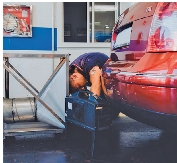
Un empleado prueba las emisiones de un vehículo
