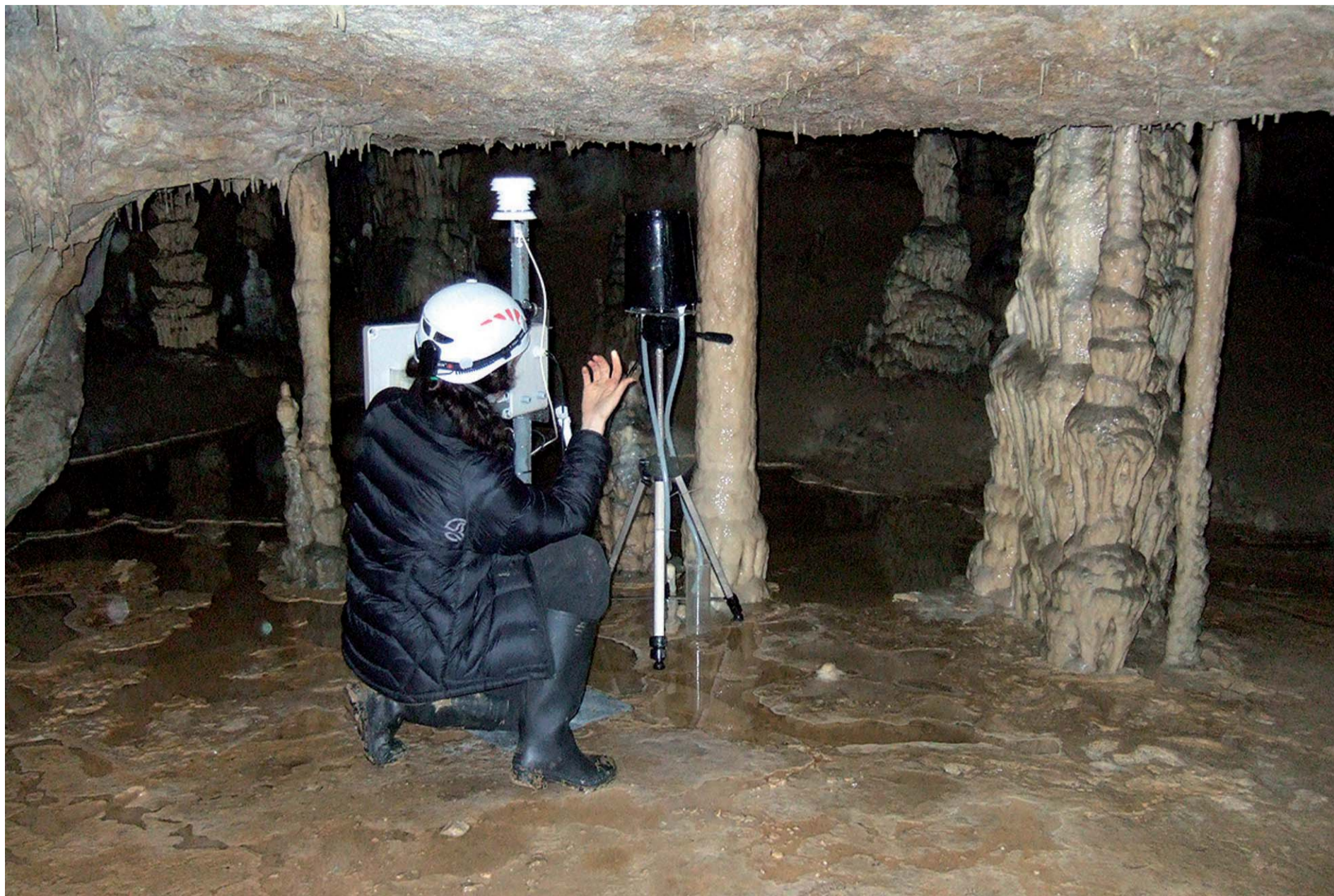
En la Cueva de Altamira se realizan estudios sobre el comportamiento del dióxido de carbono en relación a otros gases como el radón o el metano.
